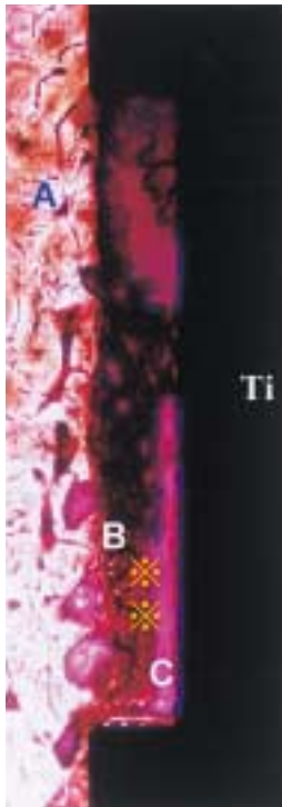
図3 HAPコーティングを施した骨計測用インプラントと新生骨との癒着
