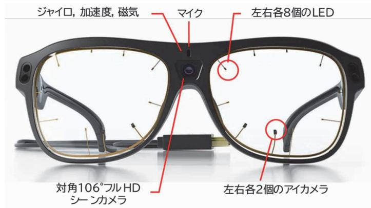
図1. ウェアラブル視線計測器（Tobii Pro Glasses 3、Tobii）
