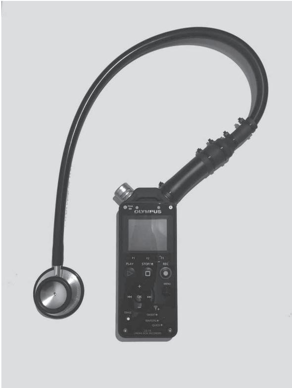
図3 聴診器とレコーダーを組み合わせた録音装置
