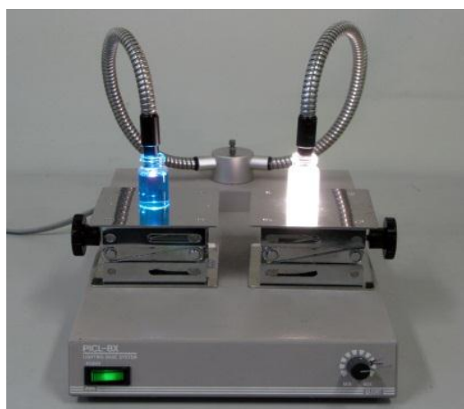
図 1 アパタイト光触媒によるメチレンブルー水溶液の退色実験 10ppmMB 水溶液に対するハロゲンランプ光照射下の退色変化， 左のガラス瓶はコントロール，右のガラス瓶は La-0AP 粉末を含む 架台は照射器本体
