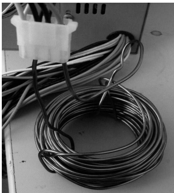
写真 2 コイルへの大電流通電実験
